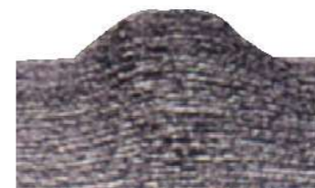
Warmgewalztes Gewinde (SAH) Hot rolled thread
