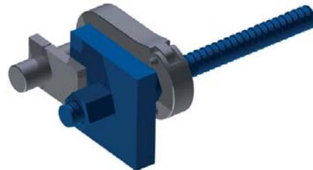
3. Aufsetzen des hydraulischen Kontergerätes auf die noch freie Anker- oder Kontermutter am Stabende. Dabei sollte zur Abstützung das Kontergerät sehr nahe zur Achse des Gegenhalters stehen. Kontergerät mit Schlauch an die Hydraulikpumpe anschließen.
