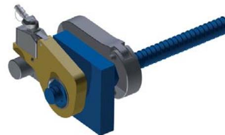
4. Öldruck der Hydraulikpumpe anhand des Kalibrierzeugnisses einstellen. An der Fernbedienung die Taste "Ein-Vor" drücken. Der Sechskanteinsatz des Kontergerätes dreht sich. Loslassen der Taste "Ein-Vor" sobald sich der Sechskanteinsatz nicht mehr dreht. Der Sechskanteinsatz ratscht zurück. Diesen Vorgang wiederholen, bis keine Drehbewegung des Sechskanteinsatzes mehr sichtbar ist, d.h. der Sechskanteinsatz nicht mehr ratscht. Das Drehmoment ist erreicht.
