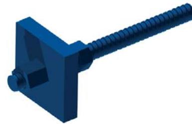
2. Aufsetzen des Gegenhalters auf die Anker- oder Kontermutter (Sechskantbügel). Verschließen des Bügels mit Bolzen. Bei der Drehrichtung das Linksgewinde des Gewindestabes beachten.
