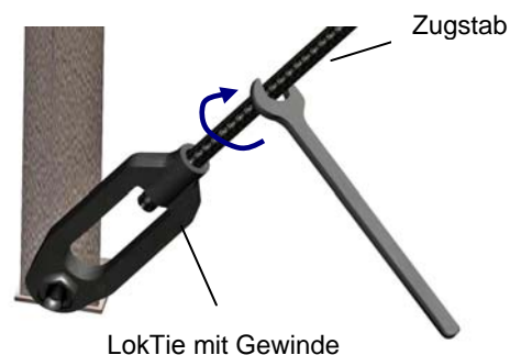
Bild 4.2: Detail „Spannen“ des Zugstabes
