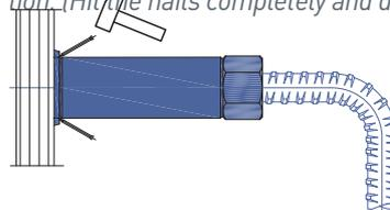
5 Entfernen der Nagelplatte unmittelbar nach dem Ausschalen (spätestens nach 5 Stunden).
