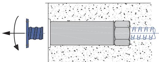
6 Einschrauben des Anschlussstabes und Kontern der Kontermutter mit Drehmomentschlüssel oder hydraulischem Kontergerät.
