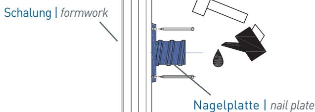
2 Abgewinkelte Halbmuffenstäbe: Nagelplatte mit Schalöl einölen und in die Muffe einschrauben.
