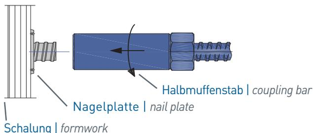
4 Muffenstoß in gewünschter Position mit Nägeln auf der Schalung befestigen. (Nägel ganz einschlagen und nicht umbiegen.)
